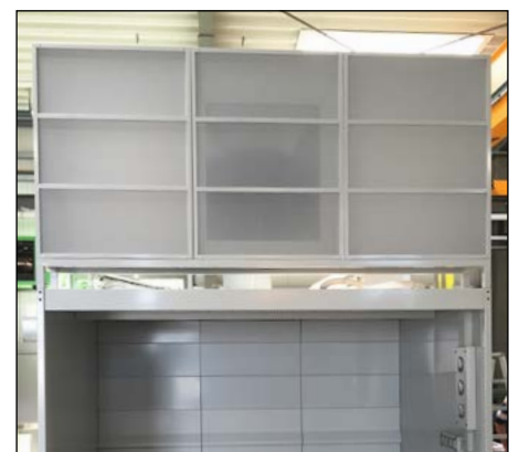
Plenum obiegu powietrza do oddawania przefiltrowanego powietrza do pomieszczenia
