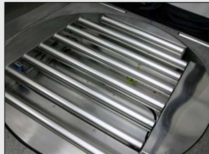
Stół obrotowy do palet , wpuszczony w podłogę stół dużej nośności; sterowany przez monitor HMI we wnętrzu i połączony z głównym systemem przenośnika taśmowego.
