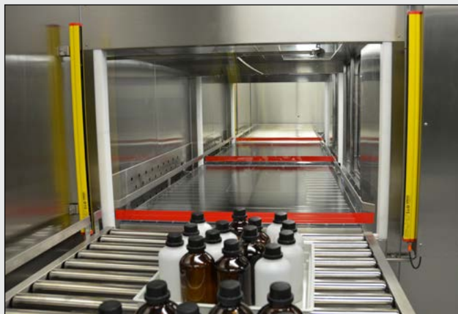
Powietrzna służa materiałowa z systemem suszenia rozpyłowego do dezynfekcji IPA
