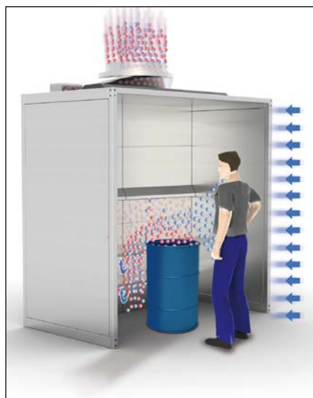
Zasada działania swobodnego stanowiska roboczego typu Compact
