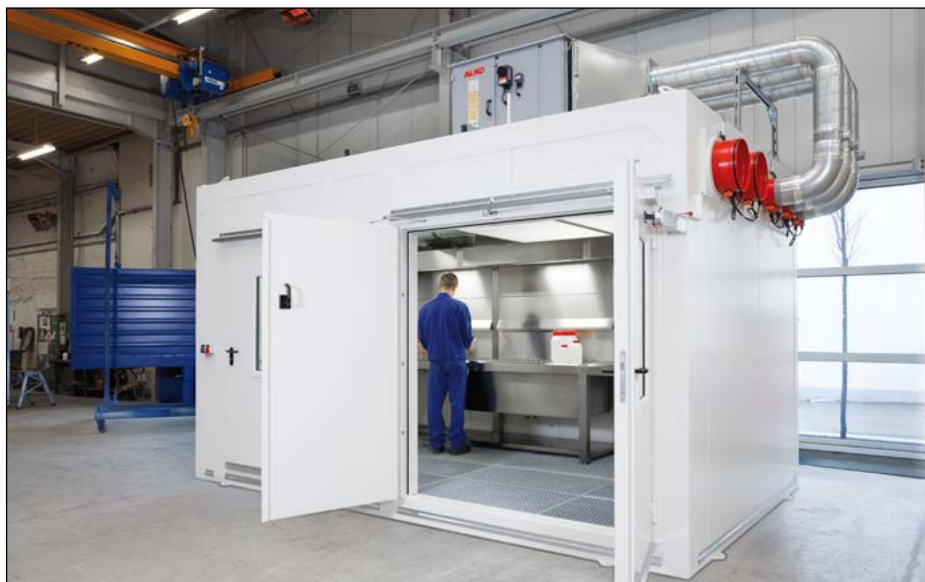
Próbna eksploatacja urządzenia w DENIOS w ramach wspólnego z klientem odbioru produktu (FAT)
