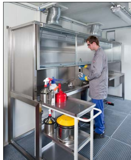
Stół roboczy typu Compact do mieszania farb i lakierowania, zabudowany w przeciwpożarowym kontenerze DENIOS z serii WFP.
