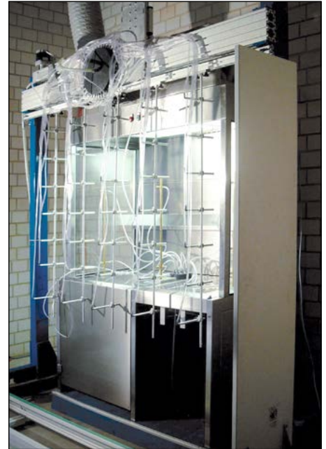
Stół roboczy VARIO-Flow (typu Premium) przygotowany do badania zdolności zatrzymywania szkodliwych substancji
