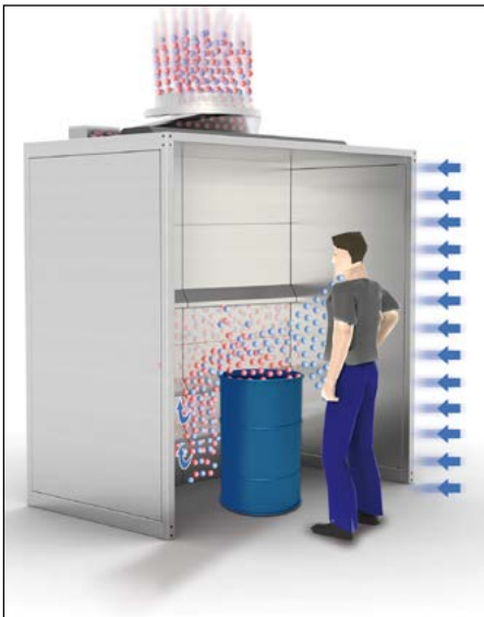
Zasada działania swobodnego stanowiska roboczego typu Premium
