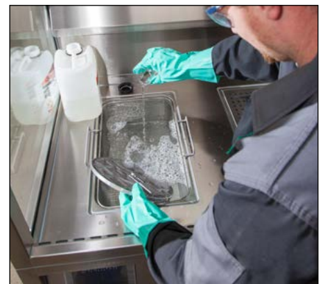
Myjka ultradźwiękowa ze sterowaniem temperatury
