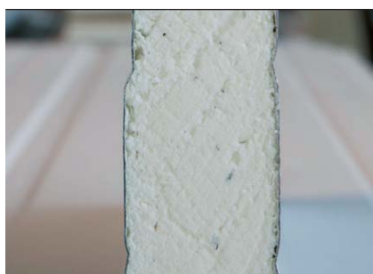
Przekrój ściany z izolacją z paneli PUR (klasa mat. budowlanych B)
