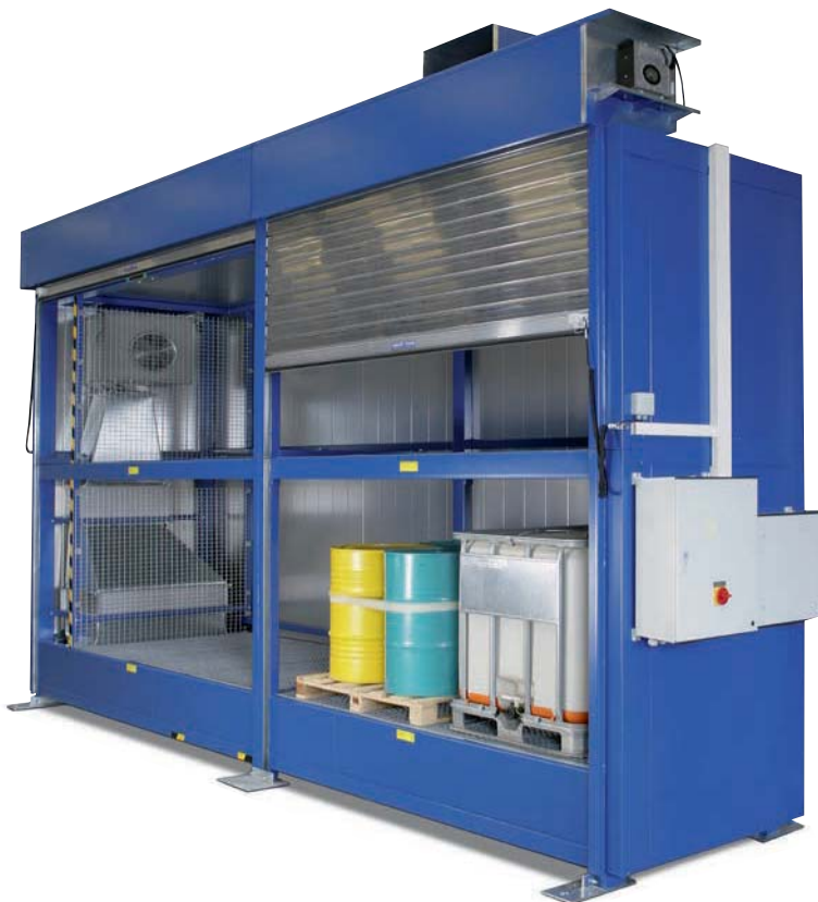
Komora grzewcza WK 614-2K z panelami cynkowanymi od wewnątrz, drzwiami żaluzjowymi i elektryczną nagrzewnicą (temperatura wewnątrz 80 °C)
