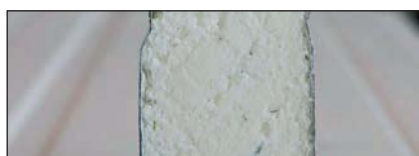
Izolacja ścienna z paneli z PUR
