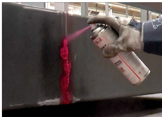
Szczelność wanien stalowych kontrolowana jest przez tzw. badanie czerwono-białe. Barwna ciecz probiercza przenika przy tym przez każdą nieregularność badanego obiektu. Przez nałożenie warstwy wywołującej wytwarza się przeciwkapilarność, która uwidoczni wgłębienia, rysy i inne wady.
