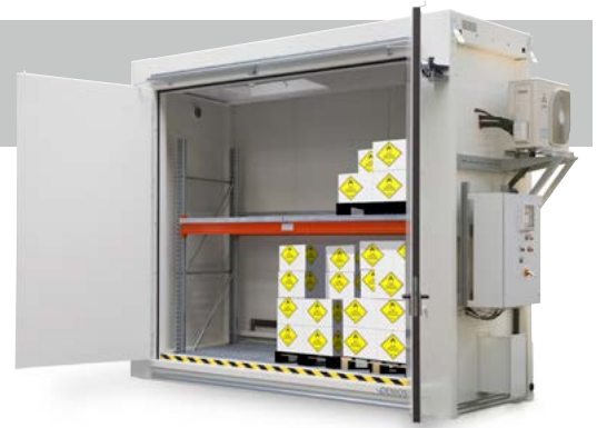
Regałowy magazyn ppoż. RFP 315.30 z klimatyzacją, ochrona ppoż. REI 120 i urządzenie redukujące ciśnienie w dachu
