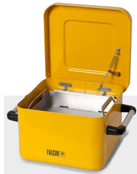
Pojemniki do zanurzenia FALCON do mycia części, z koszem ze stali szlachetnej na części i pokrywą samoczynnie zamykającą się w razie pożaru
